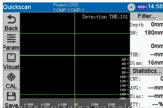
Cette fonction permet de localiser les armatures dans le béton et d'autres non ferreux matériaux de construction et d'afficher les résultats à l'écran en réel. Les armatures perpendiculaires à la direction du balayage sont présentées en vue de dessus et en coupe transversale, tandis que leurs positions peuvent être marquées directement sur la surface de balayage à l'aide des icônes gauche et droite de l'appareil.
